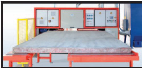
Rollengänge vor und hinter der Maschine dienen als Auf- und Absetzplatz bzw. als Bearbeitungstisch für die Elemente
