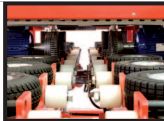
Automatischer Durchlauf über angetriebene Gummiräder und Auflagerollen
