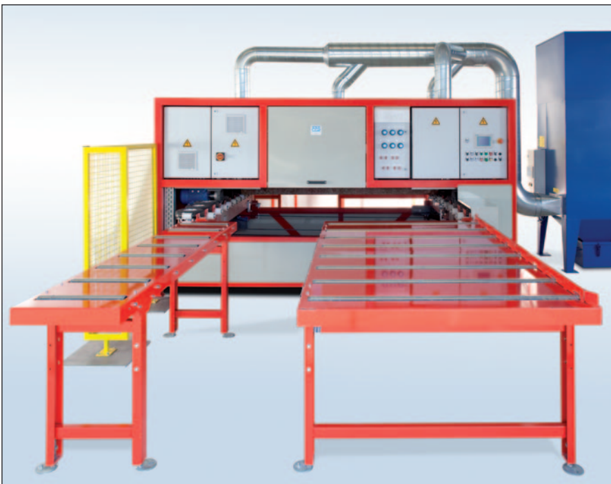
Element-Reinigungsmaschine mit Rollengängen und Absaugung
