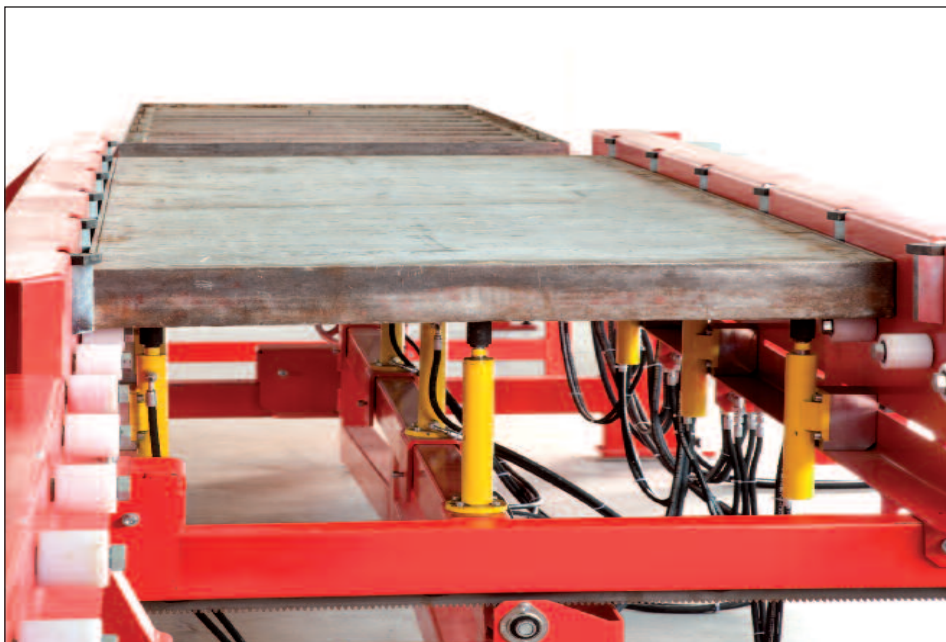
Platten-Ausdrückanlage mit Rollengängen
