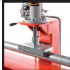
Richten der Stütze über Prismenstempel
