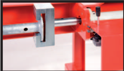
Aufnahme zum Ausziehen des Innenrohres
